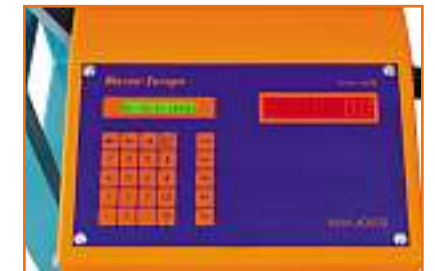
Bedienungs-pult verstellbar, zur automatischen Prozesssteuerung
